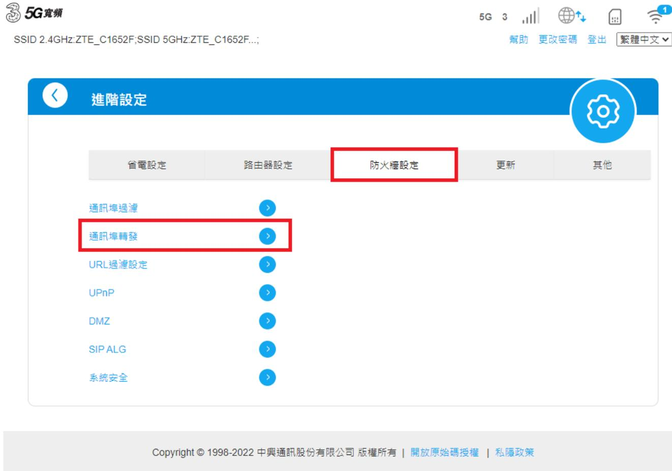
例如，如果 (1) 內部 LAN 設備的 IP 為 192.168.0.101，服務埠為 3389; (2) 外局域網使用相同的埠，可以按如下方式設置：
